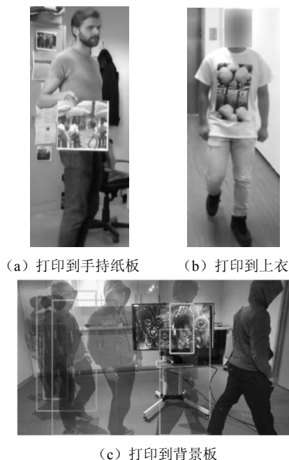
图 2 针对行人目标检测系统的可打印对抗图案攻击示例
